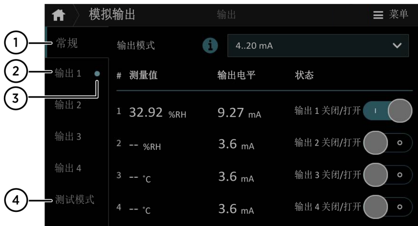
图 27 触摸屏上的模拟输出配置菜单，常规选项卡处于活动状态
